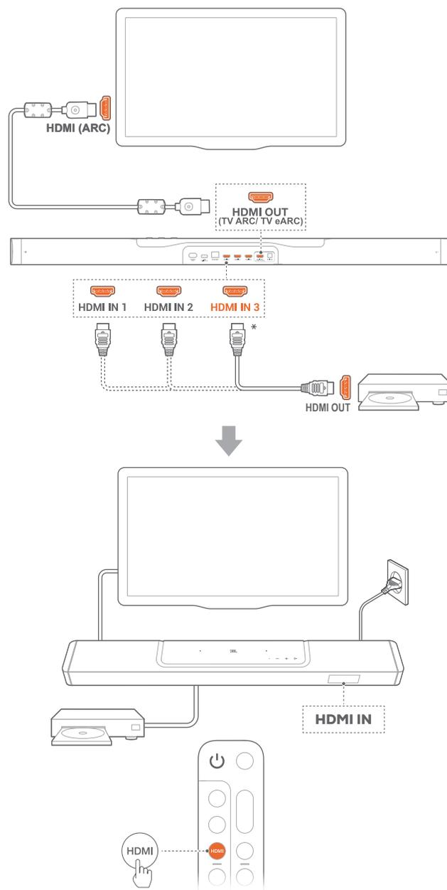
1. Connectez la barre de son au connecteur **HDMI IN (ARC/ eARC)** de votre téléviseur à l'aide du câble HDMI fourni.
